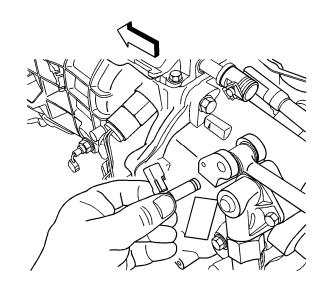
3) Remove the shift control rod pin.
