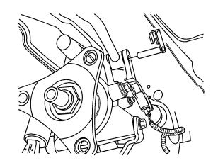
11) Remove the shift control rod pin.
